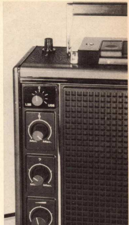
Afb. 9. De afstemknop voor de BFO (vooraan links boven) en de schakelaar voor de ijkgenerator (boven) vormen een harmonisch geheel met het bestaande bedieningspaneel.
