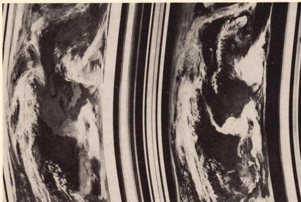
Afb. 26. Weersatellietfoto. Links opname gemaakt in het zichtbare gebied van het spectrum, rechts opname in het infrarode deel (opname Rohde & Schwarz). Op het linker deel is Denemarken duidelijk te onderscheiden terwijl rechts Scandinavië duidelijk opvalt.
